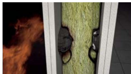
Ukázka chování protipožární přístrojové krabice
